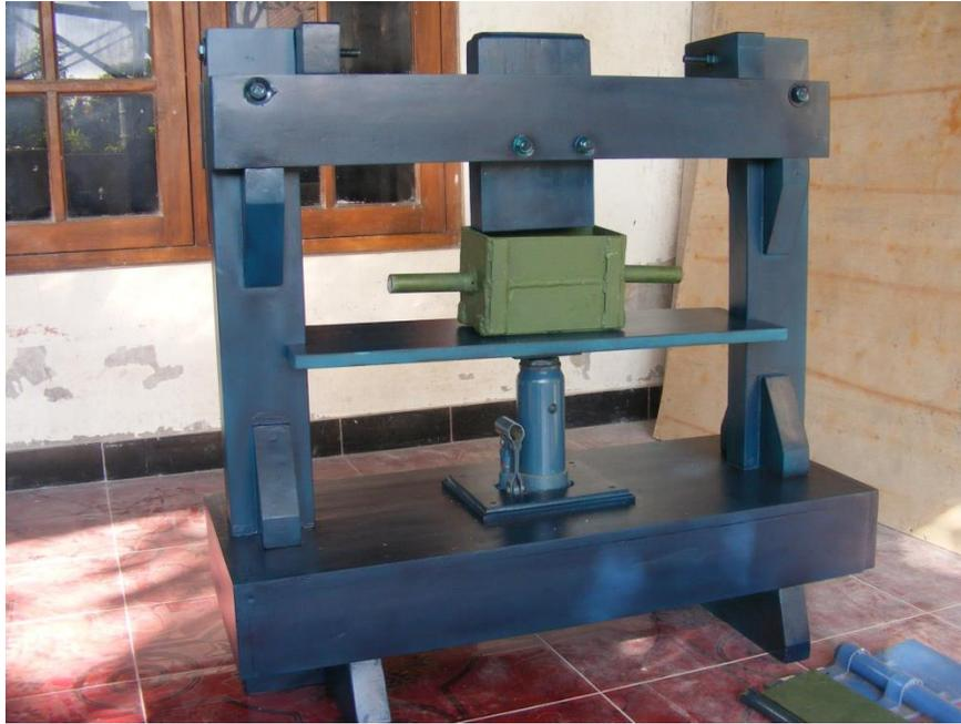
Gb. 5. Alat Cetak Pompa Hidrolik
